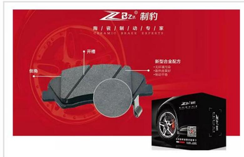
首先目前市面上刹车片主要有金属配方和陶瓷配方，陶瓷配方主要有以下几方面优点，陶瓷刹车片是从金属陶瓷而非非金属陶瓷的原理出发，刹车片由于高速大力制动时，在摩擦表面产生高温，据测定，可达到800~900度，有的甚至更高。在此高温下，制动片表面会发生金属陶瓷烧结类似反应，使刹车片在此温度下有良好的稳定性。而传统的刹车片在此温度下不会产生烧结反应，由于表面温度急剧升高会使表面物质熔化甚至产生气垫，这就有造成连续刹车后刹车性能急剧降低或者刹车全失的情况。）陶瓷刹车片与传统刹车片大差别是没有金属。传统刹车片中金属是主要产生摩擦力的材料，制动力大，但是磨损大，而且易出现噪音。安装陶瓷刹车片后，在正常行驶中，不会产生异常器叫（即刮擦声）。因为陶瓷刹车片中不含金属成份，所以就避免了传统金属刹车片与对偶件（即刹车片与刹车盘）相互磨擦的金属器叫声。稳定的摩擦系数。摩擦系数是任何摩擦材料重要的性能指标，关系刹车片制动能力的好坏。在刹车过程中由于摩擦产生热量，工作温度的增高，一般的刹车片的摩擦材料受温度的影响，摩擦系数开始下降。在实际的应用中会降低摩擦力，从而降低了制动作用。普通刹车片摩擦材料不成熟。
