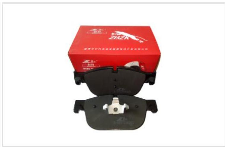
陶瓷刹车片是刹车片的一种，包括矿物纤维、芳纶纤维和陶瓷纤维（因为钢纤维会锈蚀，产生噪音和粉尘，因此不能满足陶瓷型配方的要求），比其他的刹车片颜色更淡并且更昂贵，陶瓷型刹车片更清洁安静，并且在提供刹车性能的同时，不磨耗对偶件。很多消费者起初都会误认为陶瓷制成的，其实陶瓷刹车片是从金属陶瓷而非非金属陶瓷的原理出发，刹车片由于高速大力制动时，在摩擦表面产生高温，据测定，可达到800~900度，有的甚至更高。在此高温下，制动片表面会发生金属陶瓷烧结类似反应，使刹车片在此温度下有良好的稳定性。而传统的刹车片在此温度下不会产生烧结反应，由于表面温度急剧升高会使表面物质熔化甚至产生气垫，这就有造
